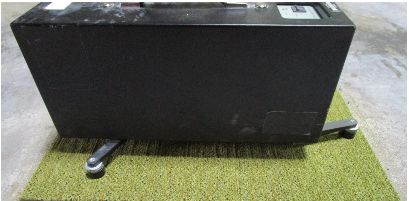
Vue d'un échantillon avec la machine à choc (essai 2) View of a sample with the tapping machine (test 2)
